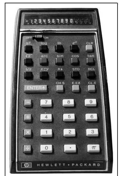
Bild 3: Der legendäre HP-35 aus dem Jahr 1972 – der erste wissenschaftlich-technische Taschenrechner der Welt – arbeitete mit UPN und kostete respektable 1890 DM.
